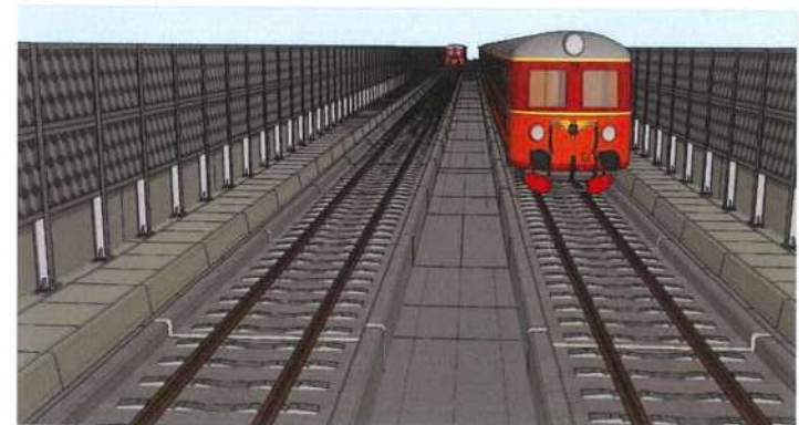
รูปที่ 2-2 รูปแบบการก่อสร้างกำแพงกันเสียงชนิดโลหะ (Metal)
