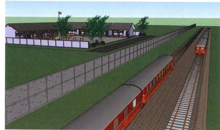
รูปที่ 2-1 รูปแบบการก่อสร้างกำแพงกันเสียงชนิดคอนกรีต (Concrete)
